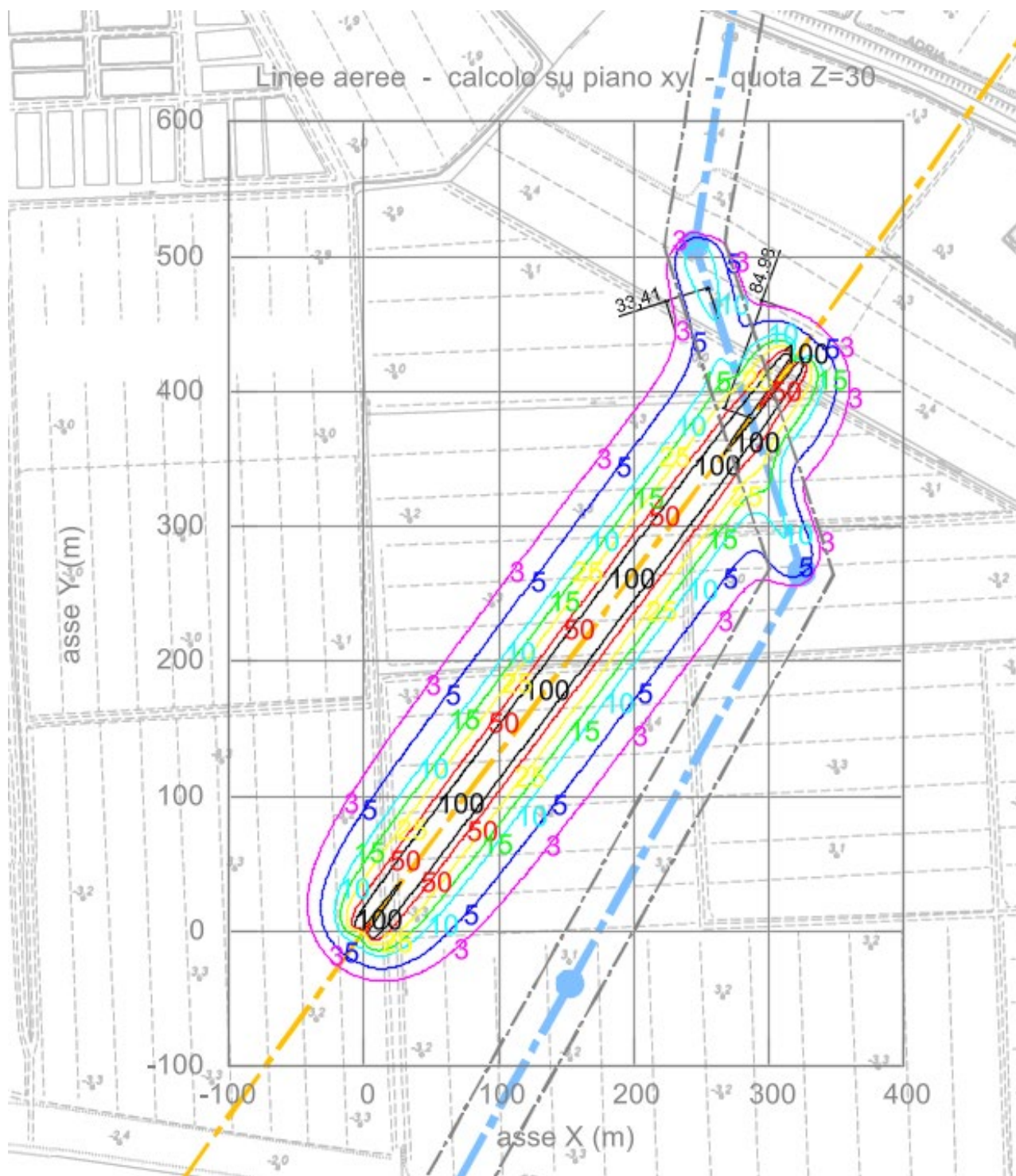
Figura 6 - Inviluppo linee a 3 \mu T a 30 m
